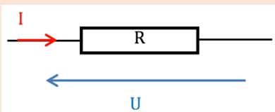
Application : Dans le circuit schématisé ci-dessus,  $U = 3 \text{ kV}$  et  $R = 3000 \Omega$  . Calculer  $I$ .
